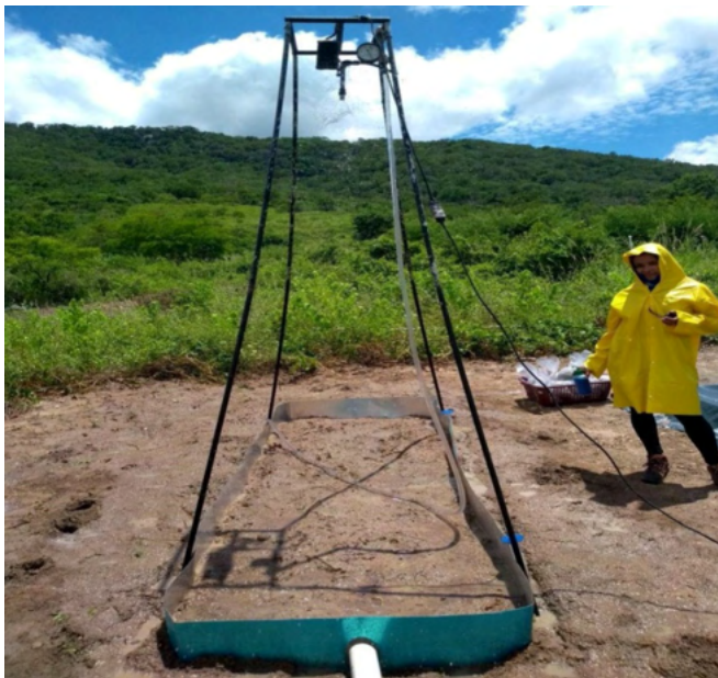
Figura 1. Parcela experimental e simulador de chuva utilizados na pesquisa.
