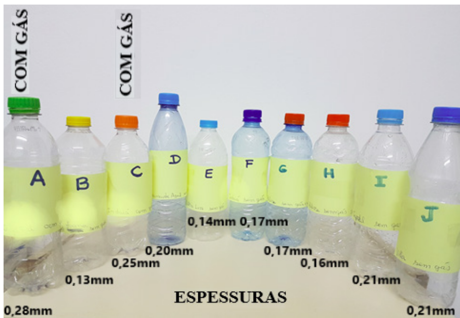
Figura 2. Amostras de garrafas PET pós-consumo, descartadas na região metropolitana do Recife, com suas respectivas espessuras médias.
