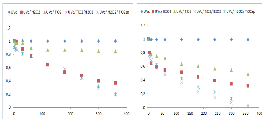
Figura 4. Curvas de degradação do efluente por processos de oxidativos avançados com duração de 360 min: (a) compostos aromáticos e (b) corante azul de metileno.
