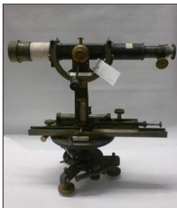
Figura 6 - Taqueômetro Charnout
