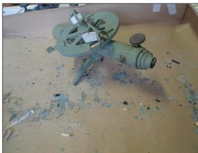
Figura 22 - Luneta de teodolito degradada
