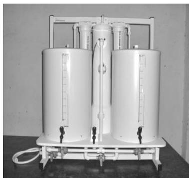
IMAGEM 1 e 2 – Conjunto Multifuncional para Água e Hidróxido de Cálcio. Fonte: Acervo Eutrópio Bezerra.
