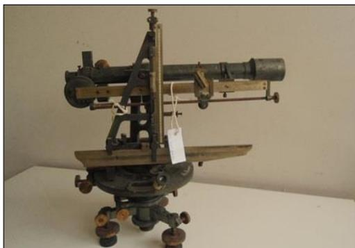
Figura 5 - Taqueômetro Springer auto-reduzor
