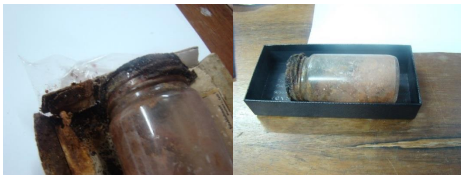
IMAGEM 2 - Constatação de perda parcial da estrutural da tampa vedação, por oxidação generalizada, provocando derramamento de fragmentos da amostra em torno do recipiente secundário, que fazia parte de seu acondicionamento original. Retirando o material para uma outra caixa de papelão, provisória, para preservar das condições de umidade e transmissão de temperatura por condução térmica.
