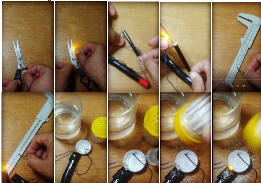
Imagem 3 – teste de condutividade de diferentes materiais.
