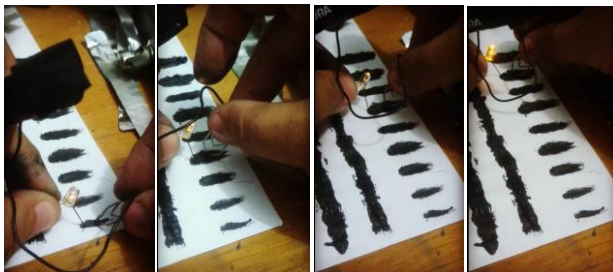
Imagem 6 – teste de condutividade e resistência da tinta condutiva.
