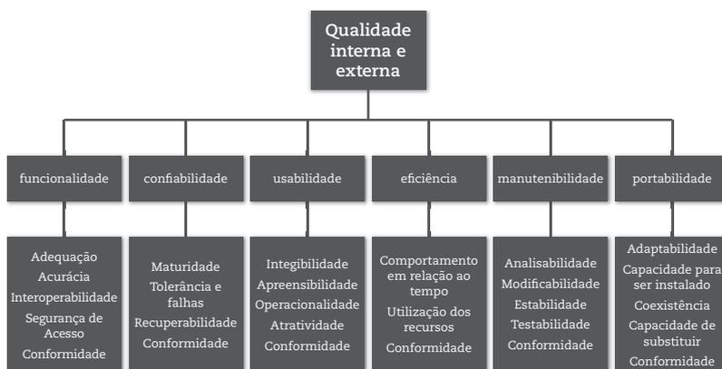
Figura 15. Modelo de qualidade interna e externa, segundo a ISO/IEC 9126-1
