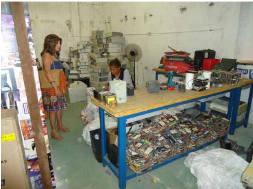
**Figura 9.** Área organizada para processamento de resíduos eletrônicos na CAMAPET. Bancada, ferramentas, bags e outros equipamentos foram adquiridos pelo projeto.
