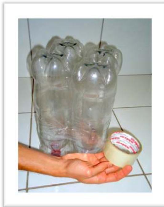
Figura 9.5. Envolvendo as garrafas pet com a fita adesiva de quatro em quatro
