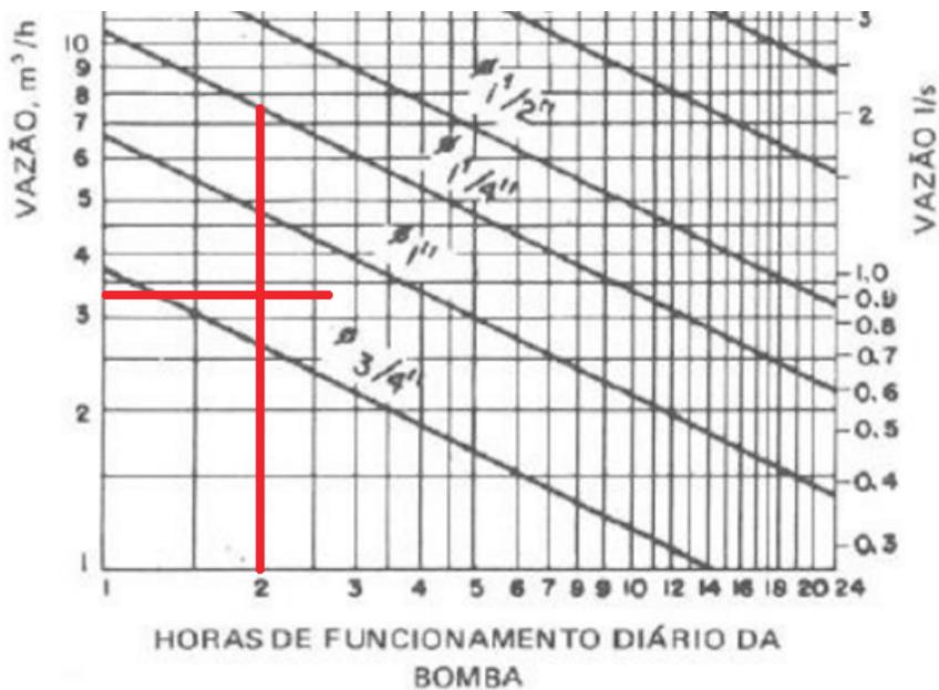
Figura 1.13.4.5 – Gráfico do diâmetro da tubulação de recalque
