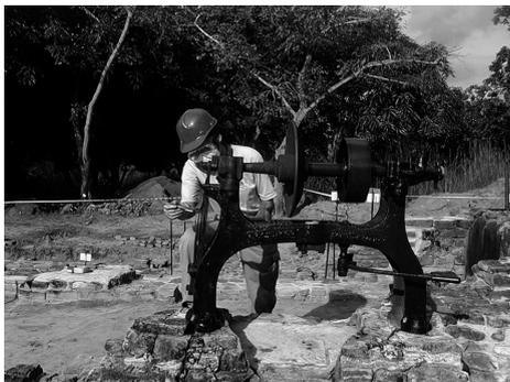
Figura 9: Peça remanescente sendo tratada contra a corrosão.
