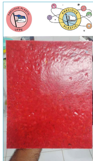
FIGURA 18. Placa feita com plásticos reciclados (tampas de garrafas) no PRECIOUS PLASTIC
