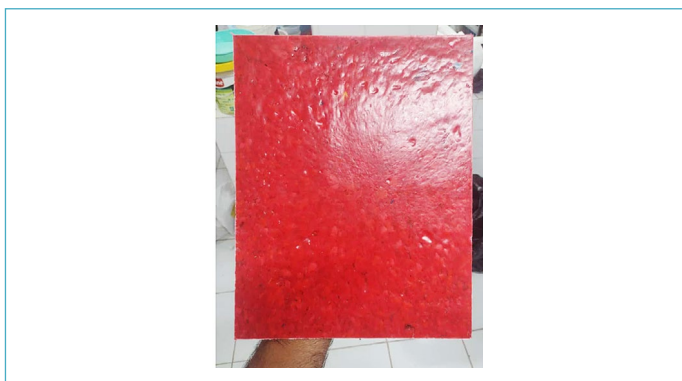
FIGURA 8. Placa feita com plásticos reciclados (tampas de garrafas) no Precious Plastic UFPE utilizada para diversos elementos específicos da maquete do Mosteiro
