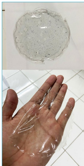
FIGURA 17. Bioplástico transparente produzido no LITPEG
