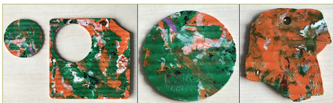
FIGURA 3. Placa reciclada a partir de resíduos de impressão 3D, com testes de corte a laser
