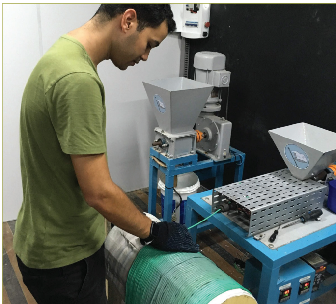
FIGURA 12. Produção de lixeira para espaço público utilizando extrusora de plástico – Laboratório Plástico Precioso Pilar
