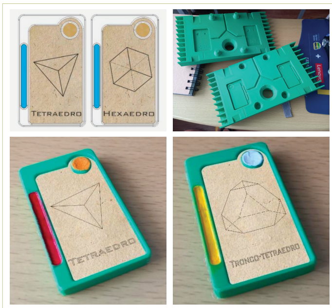
FIGURA 8. Trabalho de conclusão de curso para criação de molde de baixo custo com impressão 3D para produção de material didático de ensino de geometria
