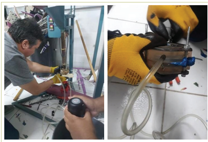
FIGURA 7. Montagem do molde para injeção
