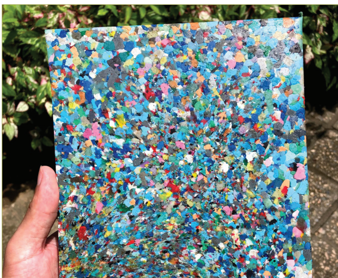
FIGURA 11. Placa de plástico reciclado utilizada para criação de diversos produtos: mobiliário, objetos de decoração, painel sensorial, dentre outros
