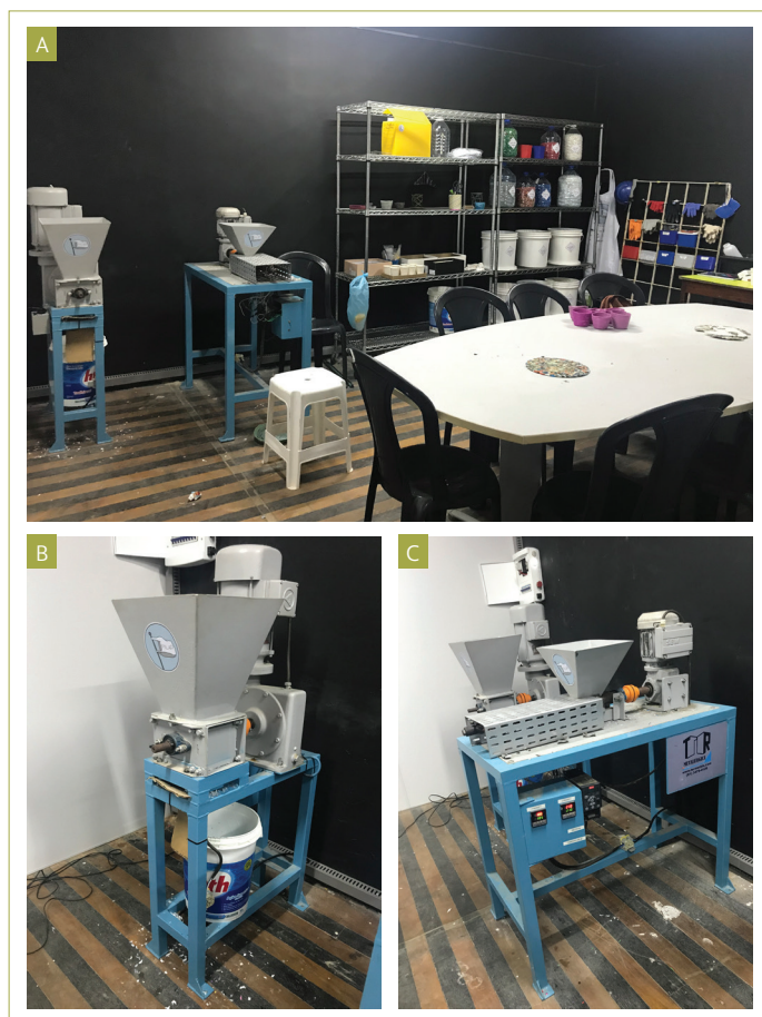
(A) Laboratório de reciclagem criativa Plástico Precioso Pilar; (B) Trituradora de plástico; (C) Extrusora de plástico de plástico. Fonte: Leticia Mendes (2019).
