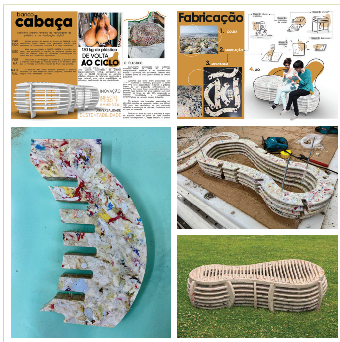
FIGURA 9. Mobiliário urbano inspirado numa cabaça, processo de produção e resultado final
