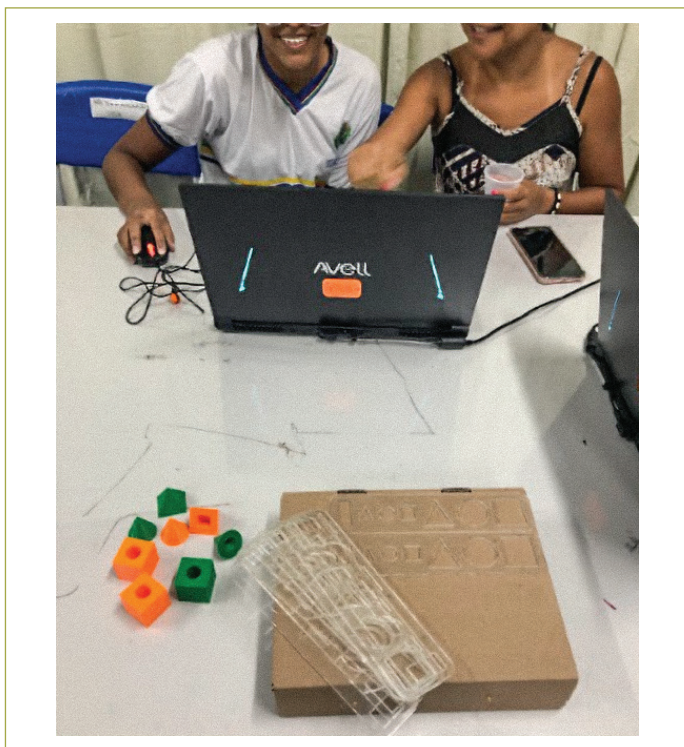
FIGURA 2. “Réguas-gabarito” desenvolvidas na oficina da EREM Olinto Victor através de modelagem do artefato em 2D no software CorelDraw e fabricação com acrílico utilizando máquina de corte a laser
