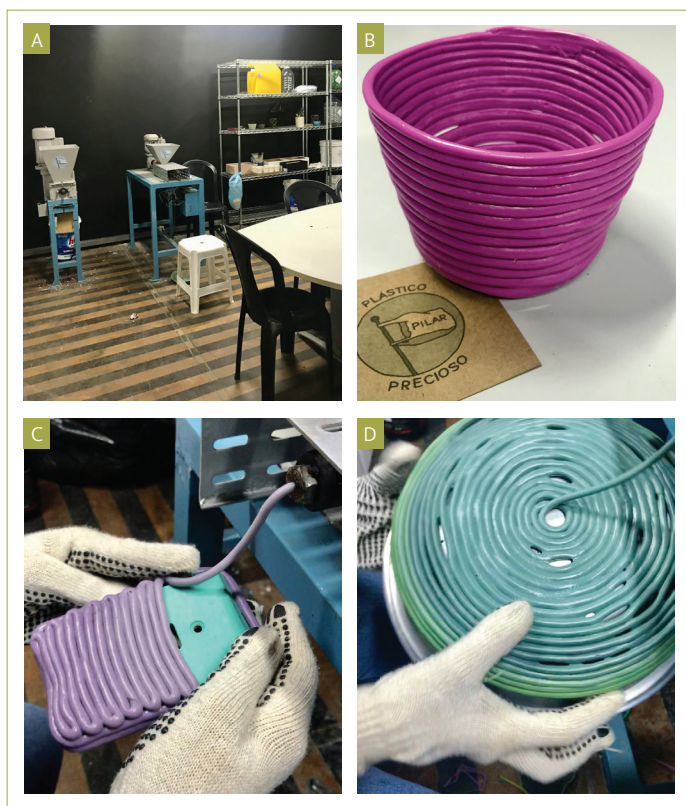
(A) Laboratório de reciclagem Plástico Precioso Pilar, implantado na Comunidade do Pilar; (B) Vaso produzido no laboratório; (C) Produção de saboneteira com extrusora; (D) Confecção de fruteira com extrusora. Fonte: Leticia Mendes (2019).
