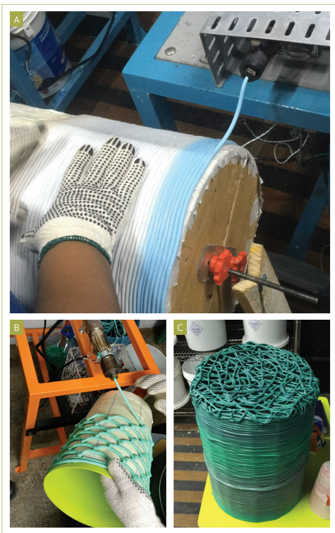
(A) Processo de produção de lixeira utilizando molde e extrusora de plástico reciclado; (B) Produção de cesto com detalhes a partir do uso de moldes; (C) Lixeira produzida com plástico reciclado para instalação em áreas de intervenção do Programa Mais Vidas nos Morros. Fonte: César Araújo (2019).
