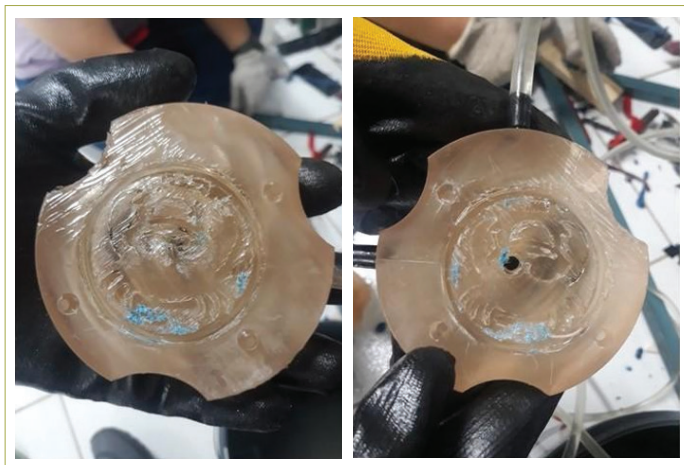
FIGURA 6. Metade sem resfriamento (esquerda) e metade resfriada (direita)
