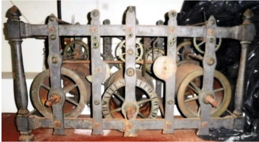
Figura 14 - Detalhe do sistema do relógio da firma Thwaites& Reed , instalado no 5º andar do Edifício de Fiscalização do Porto (Torre Malakoff) no Recife. Foto: Marcia Cristina Alves, 2015.
