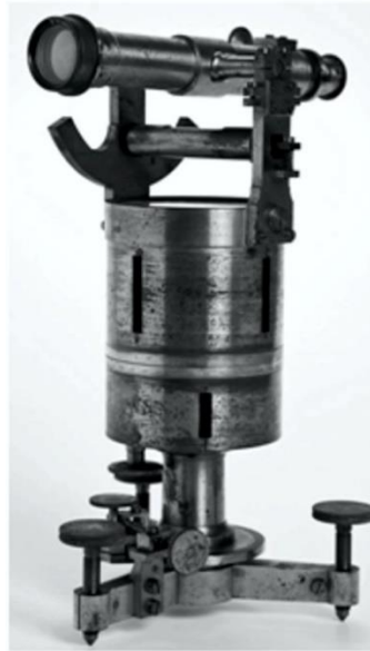
Figura 16 - Pantômetro c/ luneta e bússola - Fabricante BrunnerFrères - França - Século XIX - 1994/ 0212. Acervo MAST
