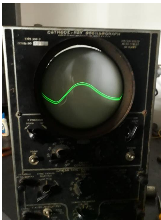
Figura 2 - O osciloscópio DuMontType 208-B após a restauração no Setor de Eletrotécnica/MCT/EM/UFOP exibindo uma onda.
